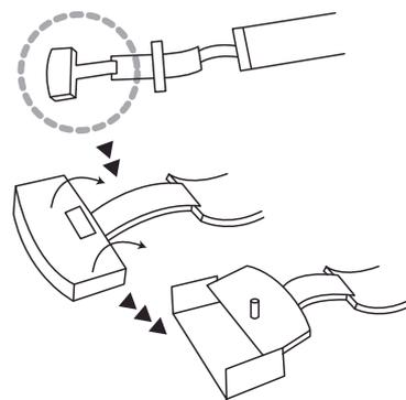
③図のように、革ベルトの先端を矢印の方向に差し入れ、腕時計を装着する手首のサイズに合わせてから、下の金具のピンをベルト穴に図のように差し込みます。差し込んだら、カチッとするまでしっかり金具を開きます。
