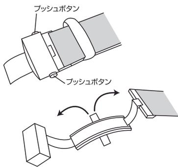
②文字盤を下にして、先端の金具を開きます。
